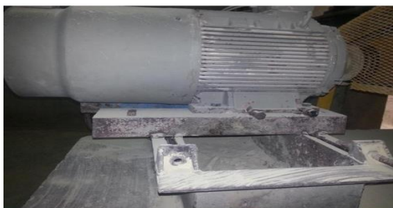
IMAGEM 11: Fabrico da base do motor principal do britador.
